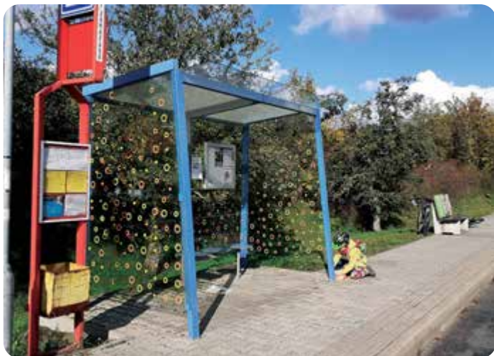
Takto vypadá efektivně zabezpečená zastávka. Nálepky jsou po celé ploše a zhruba 10 cm od sebe.
